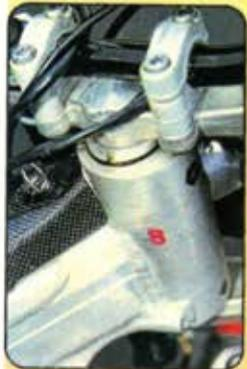
**Excentriques.** Vue sur la Montesa de Bilbao, une colonne de direction équipée de bagues excentriques permettant de faire varier l'angle de chasse en les interchangeant rapidement. L'Espagnol teste actuellement plusieurs configurations de géométrie plus efficaces en non-stop.
